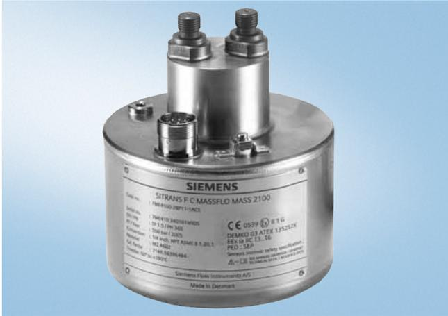
MASS 2100 DI 1.5 适于测量各种液体和气体的小流量。
